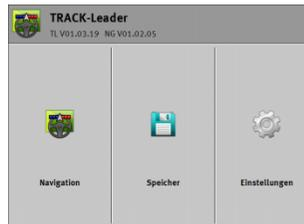
4. Jetzt müssen Sie ein Profil der Maschinenkombination anlegen (Traktor + Arbeitsgerät). Dafür tippen Sie auf „Einstellungen“.
