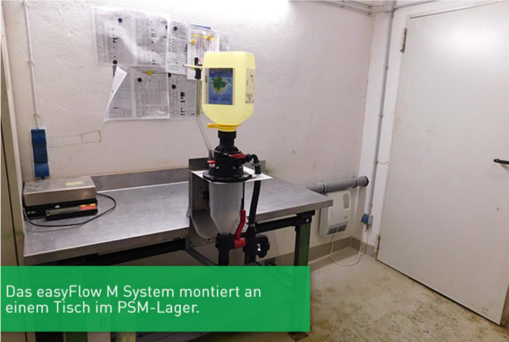
Das easyFlow M System montiert an einem Tisch im PSM-Lager.
