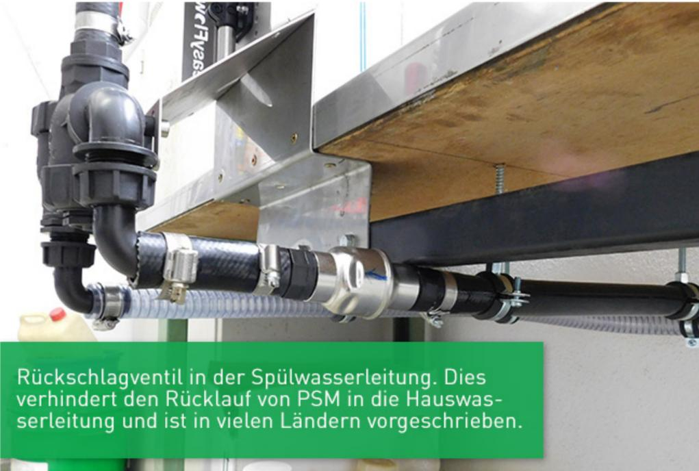
Rückschlagventil in der Spülwasserleitung. Dies verhindert den Rücklauf von PSM in die Hauswasserleitung und ist in vielen Ländern vorgeschrieben.
