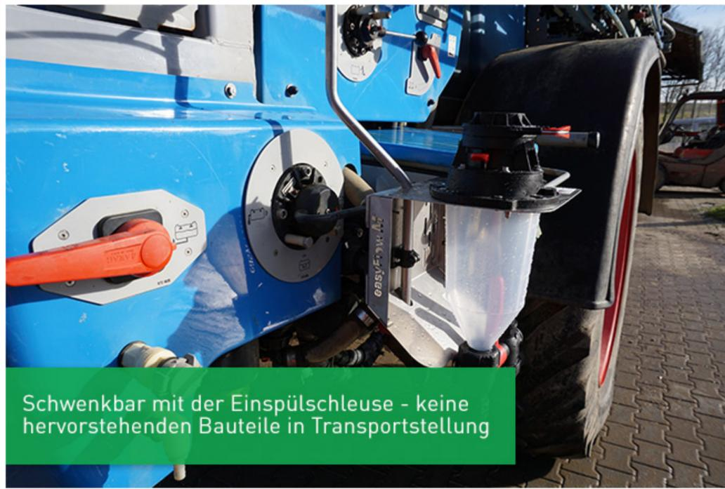
Schwenkbar mit der Einspülschleuse - keine hervorstehenden Bauteile in Transportstellung
