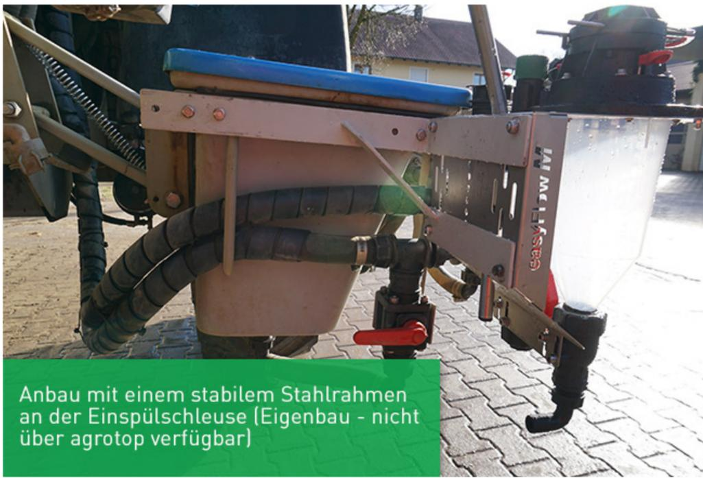
Anbau mit einem stabilem Stahlrahmen an der Einspülschleuse (Eigenbau - nicht über agrotop verfügbar)
