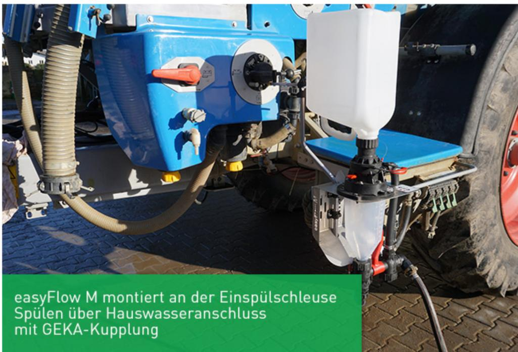
easyFlow M montiert an der Einspülschleuse Spülen über Hauswasseranschluss mit GEKA-Kupplung
