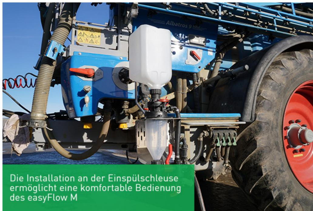
Die Installation an der Einspülschleuse ermöglicht eine komfortable Bedienung des easyFlow M
