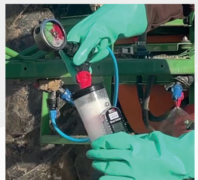
Auslitern einer Doppelflachstrahldüse mit dem SPOTON
